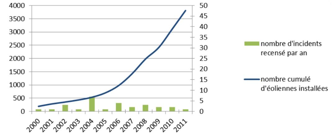
Les recensements effectués montrent que les incidents observés concernent principalement des modèles anciens ne bénéficiant généralement pas des dernières avancées technologiques (par exemple des pales en fibre de verre, plus résistantes, ou un système de freinage aérodynamique – qui équipent les éoliennes du parc du Sentier de l'Hirondelle).
